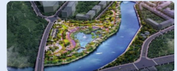
鹤壁山城区汤河流域综合治理项目将通过清淤疏浚、浚深扩宽恢复水系畅通，提升河道调蓄能力和防洪排涝功能；在不影响河道行洪、泄洪的基础上，对现有硬质护岸进行生态化改造或建设生态护岸，加强沿岸景观带建设，提升景观整体效果。
